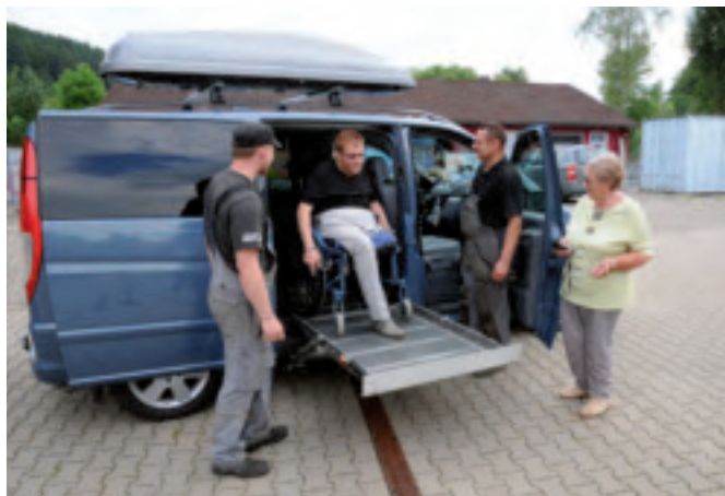
Neue Mobilität: Mit dem Kassettenlift K90 gelangt Freddy in den Viano, kann selbst auf den Schwenksitz umsteigen und sich in Fahrposition bringen
