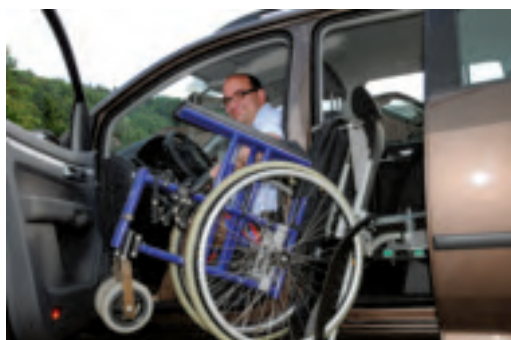
Schnell, komfortabel und kompakt: Der Ladeboy S2 Maximum mit Drehmodul zieht den Faltrölli automatisch ein, kostet im Kofferraum nur wenig Platz und lässt zwei Sitzplätze auf der Rückbank frei
