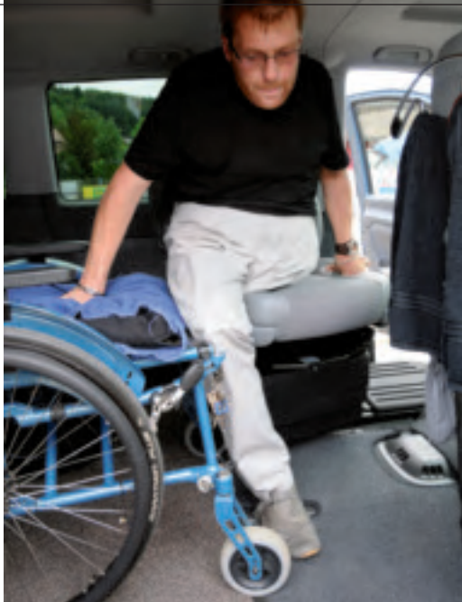
Neue Mobilität: Mit dem Kassettenlift K90 gelangt Freddy in den Viano, kann selbst auf den Schwenksitz umsteigen und sich in Fahrposition bringen
